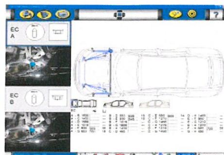
Das elektronische **Messsystem PointX** ermöglicht die elektronische Vermessung von Fahrzeugen. Nähere Informationen erhalten Sie von unserem geschulten Personal, sprechen Sie uns an.
